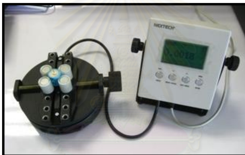
ภาพที่ 11 แสดงเครื่องทดสอบแรงบิดก่อนทำการปรับปรุงเป็นระบบมอเตอร์
