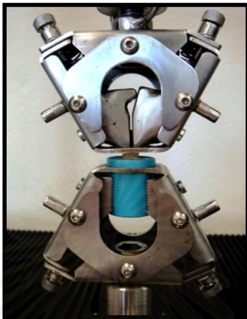
ภาพที่ 3 แสดงการทดสอบความต้านทานต่อแรงดึง
