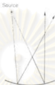
รูปที่ 2.11 การสะท้อนของเสียงบนพื้นเว้า
