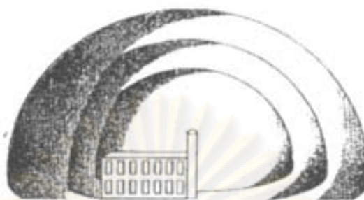
รูปที่ 2.15 แสดงการกระจายเสียงของเสียงที่มีแหล่งกำเนิดเป็นจุด (point Source)
