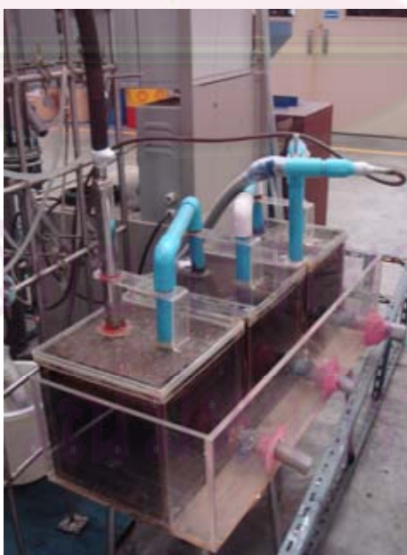
รูปที่ 3.10 อุปกรณ์สกัดน้ำมันดินออกจากผลิตภัณฑ์แก๊สที่ได้
