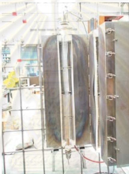
รูปที่ 3.5 เครื่องปฏิกรณ์สำหรับการทำปฏิกิริยาแกซีฟิเคชัน
