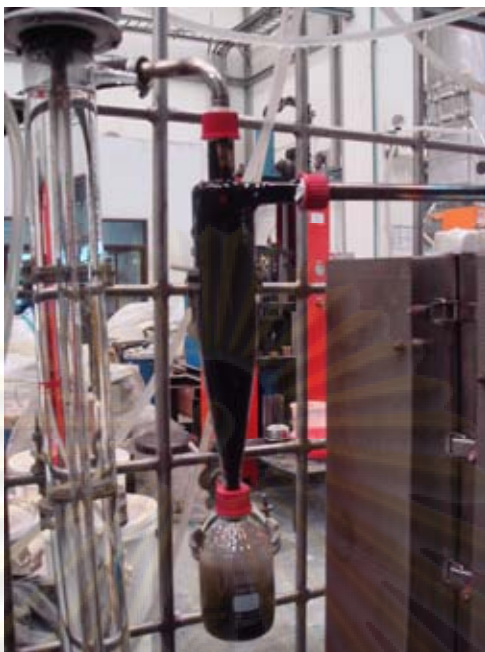
รูปที่ 3.9 ชุดอุปกรณ์ดักจับฝุ่นของแข็งที่เกิดจากปฏิกิริยา
