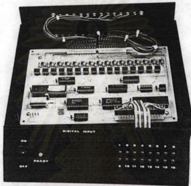
รูปที่ 4.8 แสดงแผ่นวงจรของฮาร์ดแวร์โมดูลอินพุตแบบดิจิทัล
