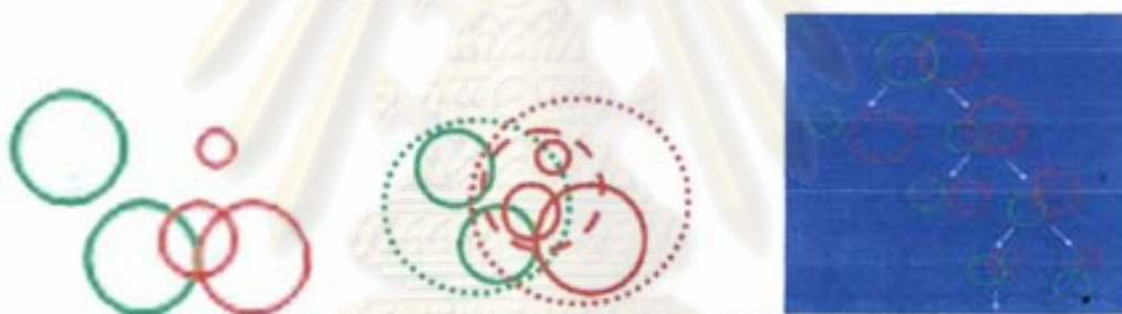
รูปที่ 2-3 การตรวจสอบการชนกันระหว่างวัตถุสีเขียวและวัตถุสีแดงด้วยวิธีบีวีเอส
