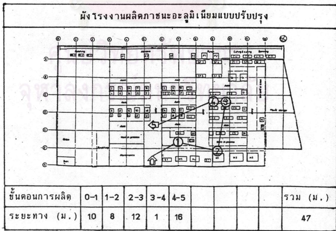
ภาพที่ ๔.๔ แสดงการไหลของวัสดุของผังโรงงานผลิตภัณฑ์อะลูมิเนียมแบบปัจจุบัน และแบบปรับปรุงของผลิตภัณฑ์ ขั้น 16 เชนติเมตร
