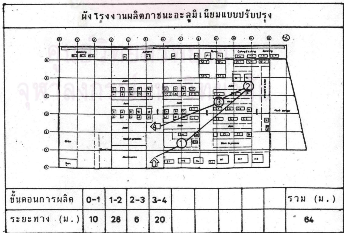
ภาพที่ 4.2 แสดงการไหลของวัสดุของผังโรงงานผลิตภัณฑ์อะลูมิเนียมแบบปั๊วบัน และแบบปรับปรุงของผลิตภัณฑ์ ชั้น 6-10 เช่นติเมตร
