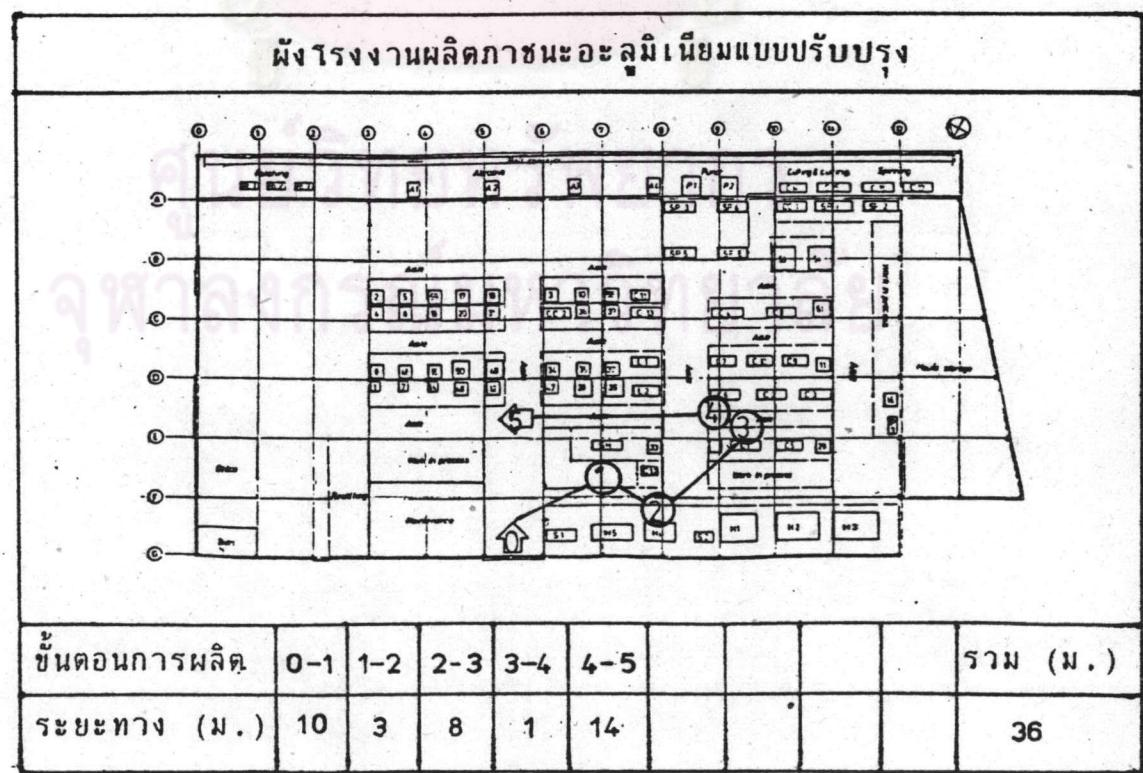
ภาพที่ ๕.๕ แสดงการไหลของวัสดุของผังโรงงานผลิตภัณฑ์อะลูมิเนียมแบบปัจจุบัน และแบบปรับปรุงของผลิตภัณฑ์ ชั้น 18 เช่นติเมตร
