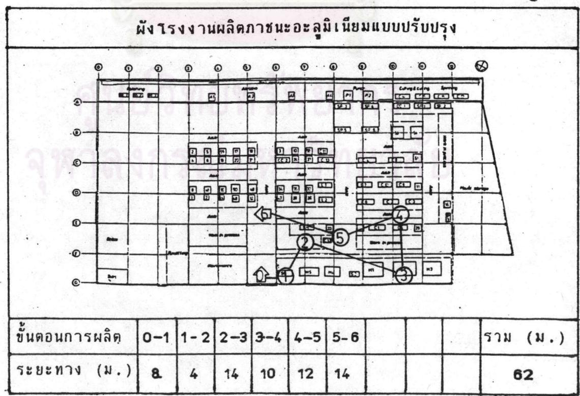
ภาพที่ ง.17 แสดงการไหลของวัสดุของผังโรงงานผลิตภัณฑ์อะลูมิเนียมแบบบัวจุบัน และแบบปรับปรุงของผลิตภัณฑ์ กันเป็นต่อ 14-16 เชนติเมตร
