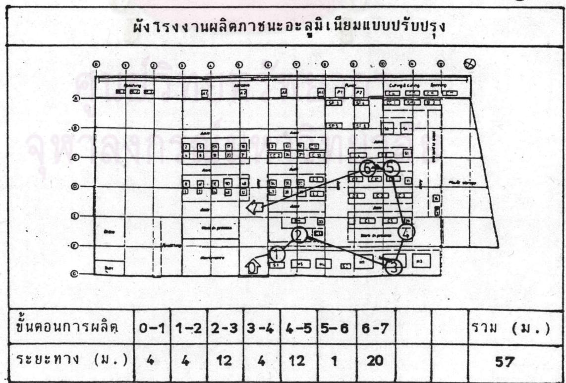
ภาพที่ 4.13 แสดงการไหลของวัสดุของผังโรงงานผลิตภัณฑ์อะลูมิเนียมแบบบีจูบัน และแบบปรับปรุงของผลิตภัณฑ์ ขาโถข้าว 20-22 เชนติเมตร
