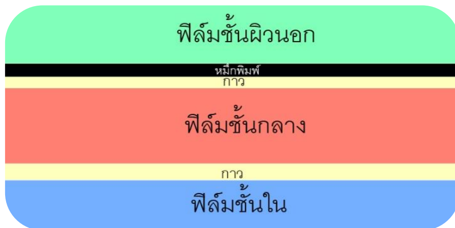
ภาพ 2-1 โครงสร้างทั่วไปของฟิล์มหลายชั้น จำนวน 3 ชั้น
