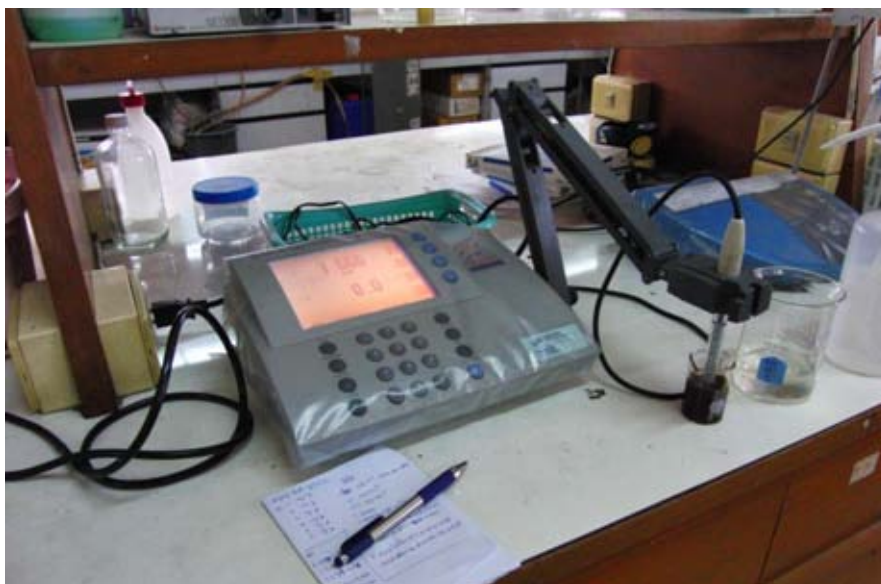
รูป 2 เครื่องวัดความเป็นกรดด่าง Denver instrument รุ่น Model 225
