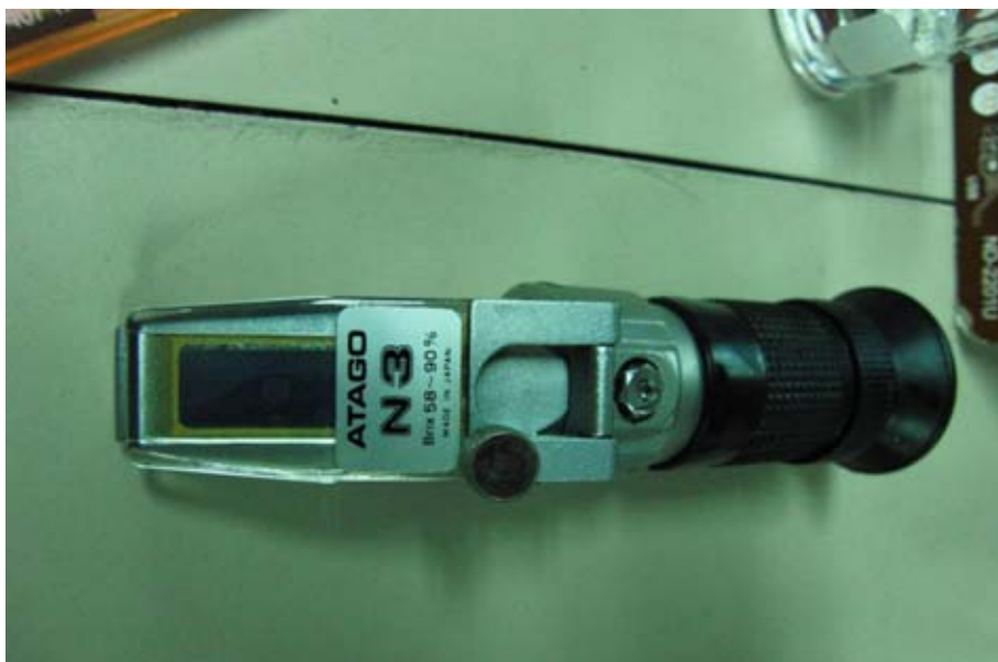
ภาพ 4 เครื่องรีแฟรกโตมิเตอร์ ATAGO รุ่น N3 วัดค่า °Brix อยู่ในช่วง 58-90%
