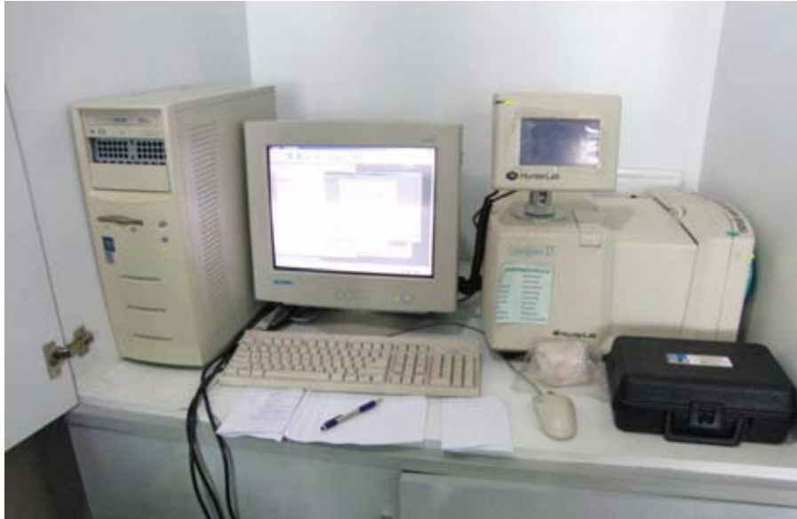
ภาพที่ 1 เครื่องวัดสีสเปกโทรโฟโตมิเตอร์ Hunter Lab รุ่น ColorQuest XT
