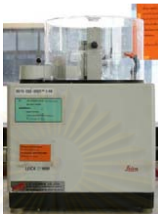
รูปที่ 8 เครื่องตัดชิ้นเนื้อเยื่อแข็ง (Microtome)
