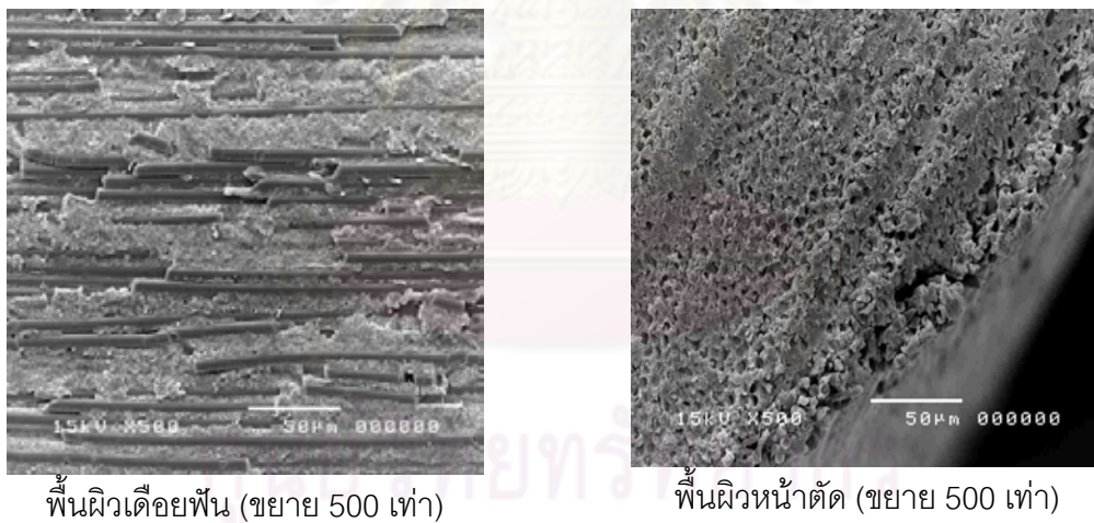
รูปที่ 49 ภาพถ่ายด้วยกล้องจุลทรรศน์อิเล็กตรอนชนิดส่องกราด (SEM) ที่กำลังขยาย 50 และ 500 เท่า แสดงลักษณะพื้นผิวเดี่ยยพื้นสำเร็จรูปเรซินคอมพอสิตเสริมเส้นใยคาร์บอนที่ทำการปรับสภาพพื้นผิวด้วย สารละลายไฮโดรเจนเปอร์ออกไซด์ความเข้มข้นร้อยละ 24 ที่เวลา 10 นาที
