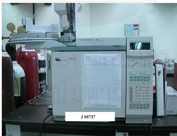
รูปที่ 3.8 เครื่องแก๊สโครมาโทกราฟีจำลองการกลิ่นรุ่น 6890N ของ Analytical control
