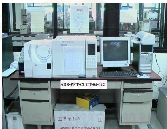
รูปที่ 3.9 เครื่องแก๊สโครมาโทกราฟีรุ่น GC2010 และเครื่องแมสสเปกโตรมิเตอร์รุ่น GCMS-
