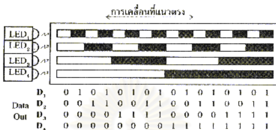
รูปที่ 2.12 แสดงออปติคอลลีนโคดเดอร์แบบสัมบูรณ์ แบบเลื่อนแนวตรงขนาด 4 บิต
