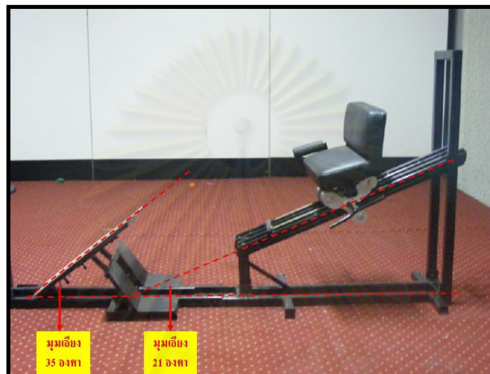
รูปที่ 3.4 แสดงความลาดเอียงของส่วนเบาะนั่งทดสอบ ที่ผู้วิจัยพัฒนาขึ้น
