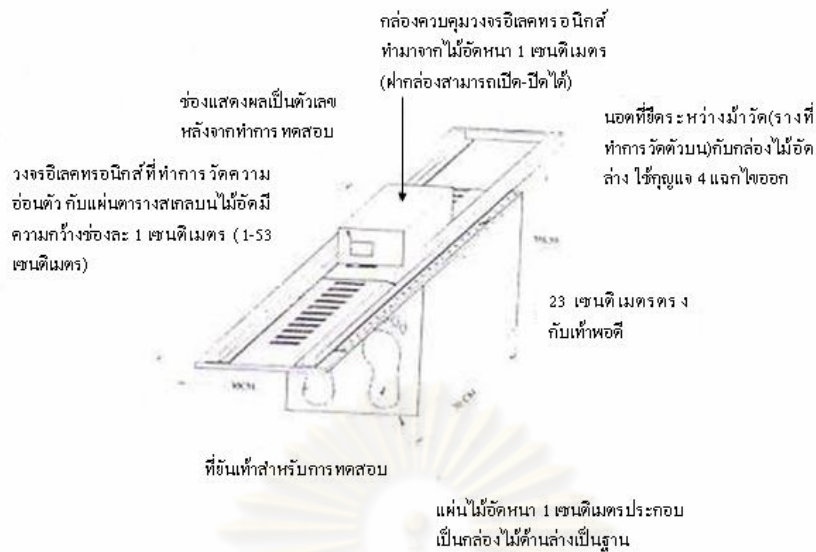
รูปที่ 2.18 แสดงเครื่องมือวัดความอ่อนตัวด้านหน้า (วราภรณ์ ไชยสุรียานนท์, 2546)
