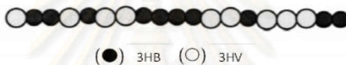
รูปที่ 2.10 การเรียงตัวของโมโนเมอร์ 3HB และโมโนเมอร์ 3HV ในสายโคพอลิเมอร์ PHBV แบบสุ่ม (Kumar และคณะ, 2001)
