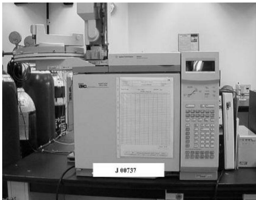
ภาพที่ 3.3 เครื่องแก๊สโครมาโทกราฟีแบบจำลองการกลั่น (simulated distillation gas chromatography : Varian CP-3800)
