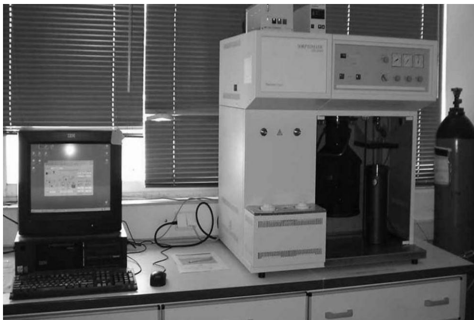
ภาพที่ 3.4 เครื่องวิเคราะห์หาพื้นที่ผิวรูพรุนทั้งหมด(BET surface area)
