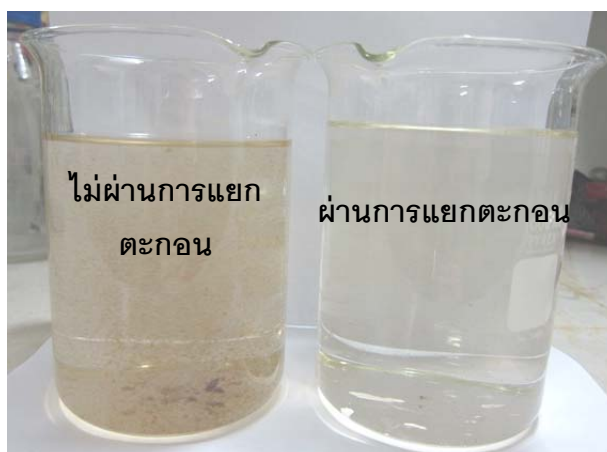
ภาพที่ 4.15 ภาพถ่ายแสดงความขุ่นของน้ำจากถังเลี้ยงสัตว์น้ำที่ยังไม่ผ่านการแยกตะกอน (ซ้าย) เปรียบเทียบกับน้ำที่ผ่านถังแยกตะกอน (ขวา)
