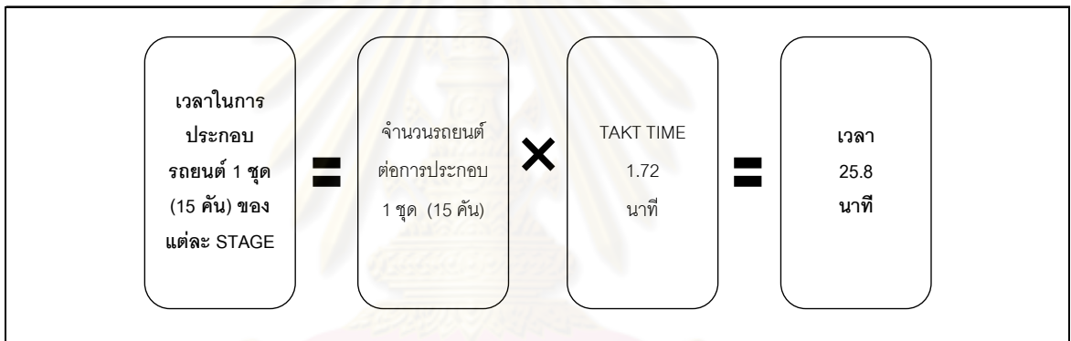
ภาพที่ 4.15 เวลาในการประกอบรถยนต์ 1 ชุด 1 ของแต่ละสถานี
