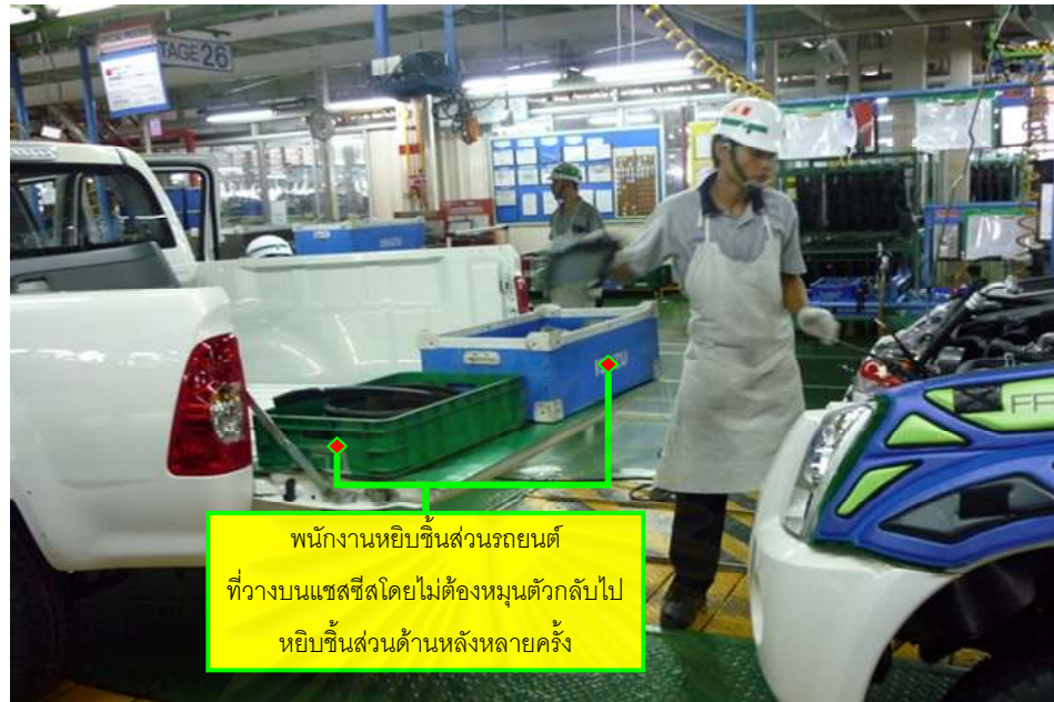
ภาพที่ 6.45 ตัวอย่างการวางชิ้นส่วนรถยนต์บนกระบะ (REAR BODY) รถยนต์
