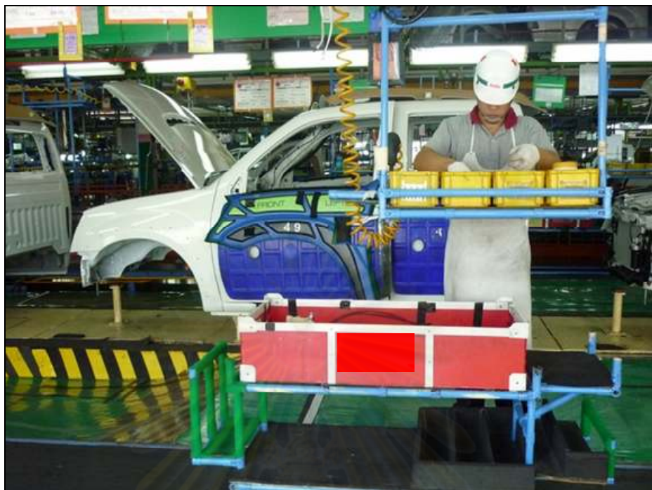
ภาพที่ 6.13 การลดพื้นที่วางชิ้นส่วนรถยนต์ข้างสายการประกอบขั้นสุดท้าย โดยห้อยชิ้นวางลงมา จากด้านบนของสายการประกอบ
