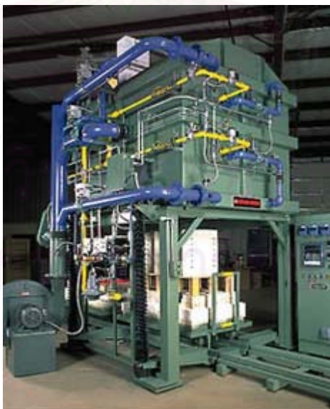
รูปที่ 3.2 รูปแสดงเตาเผาเซรามิกส์แบบยกตัวเตาขึ้นได้ (elevator kiln)
