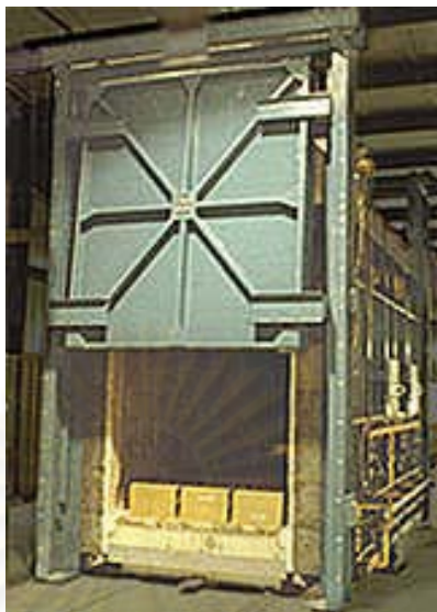
รูปที่ 3.3 รูปแสดงเตาเซรามิกส์แบบยกประตูเตาขึ้นลง (shuttle kiln)
