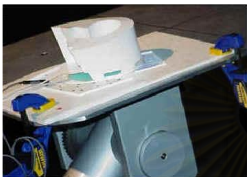
รูปภาพที่ 2.20 แสดงการติดตั้งหุ่นจำลองที่ฐานโต๊ะ
