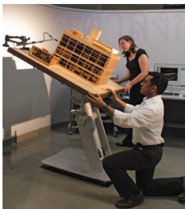
รูปภาพที่ 2.19 แสดง Platform Heliodon
