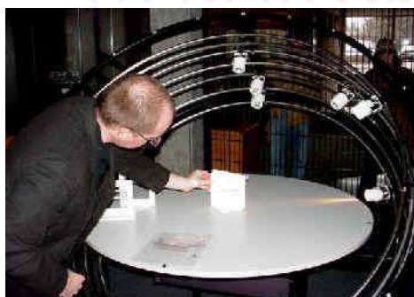
รูปภาพที่ 2.25 แสดงการติดตั้งหุ่นจำลองที่ฐานอุปกรณ์
