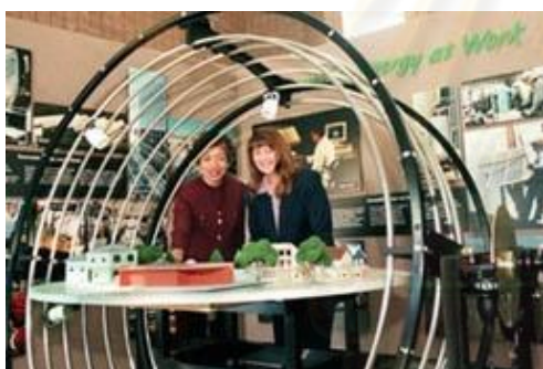
รูปภาพที่ 2.24 แสดงลักษณะของ Ring Heliodon
