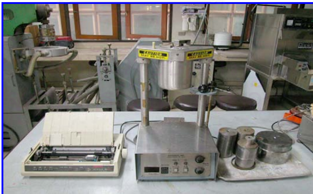
Figure 3.8 Melt flow index tester (Kayeness 7053)
