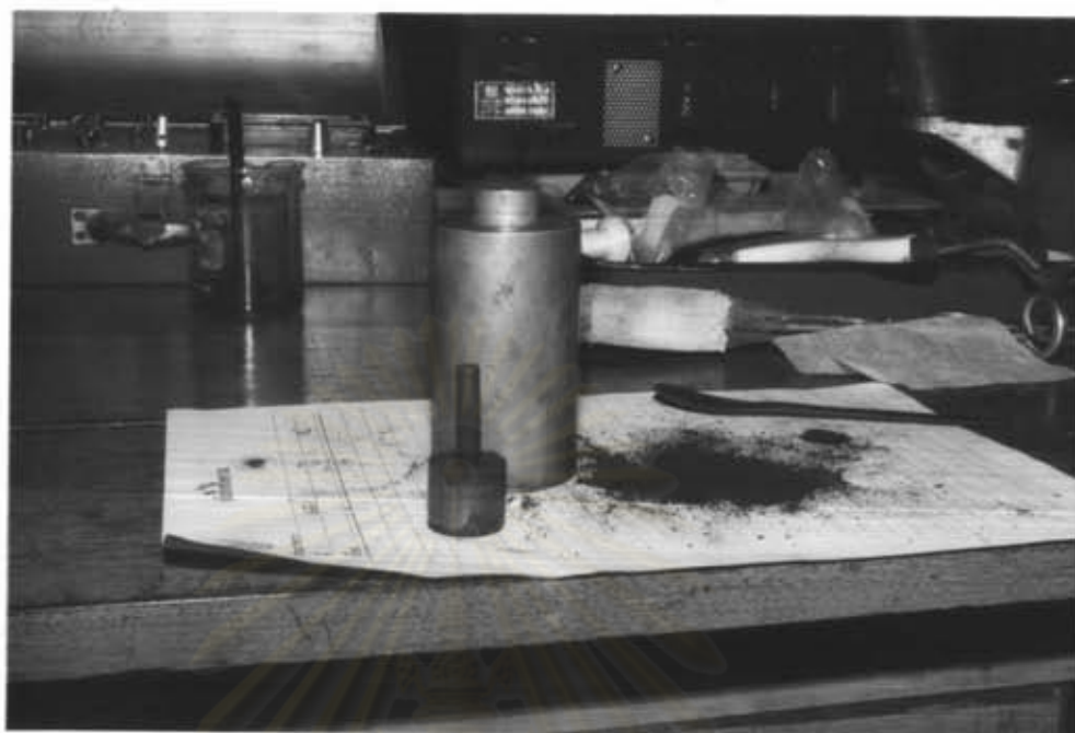
ภาพที่ ก-4 ลักษณะของแท่งตัวอย่างสีค่า (Bobbin) ที่อัดได้
