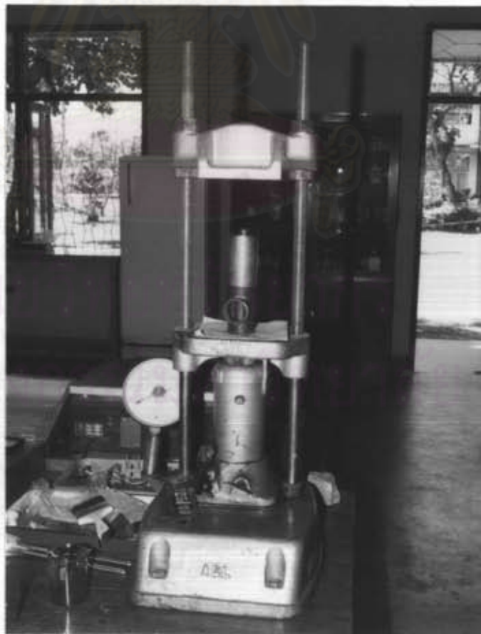
ภาพที่ ก-3 การเอาก้อนส่วนผสมสีดำออกจากแท่งทองเหลืองโดยใช้แท่งเหล็กดันด้วยเครื่องอัดไฮดรอลิก
