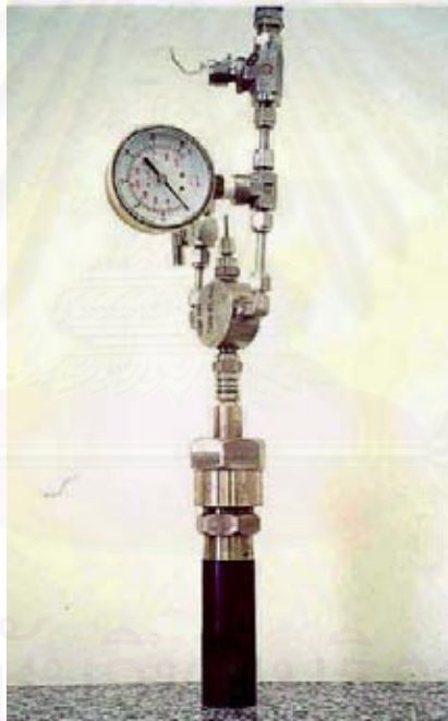
รูปที่ 3.1 เครื่องปฏิกรณ์ขนาดเล็ก ปริมาตร 75 มิลลิลิตร (Micro-reactor)
