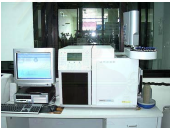
รูปที่ 3.4 เครื่องแก๊สโครมาโทกราฟีแบบจำลองการกลั่น (Simulated Distillation Gas Chromatography : Varian CP-3800)
