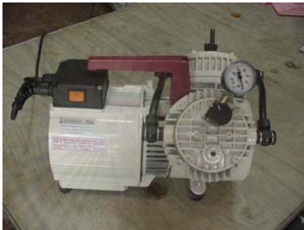
รูปที่ 3.10 ปั๊มสุญญากาศ (vacuum pump)
