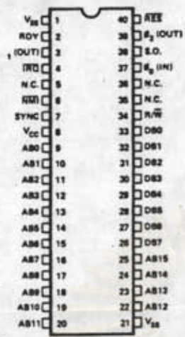
รูป 4-2 การจัดขาของวงจรถ่ายเบ็ดเสร็จ 6502
