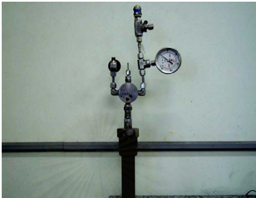
รูปที่ 3.1 เครื่องปฏิกรณ์แบบกะ (Batch reactor)
