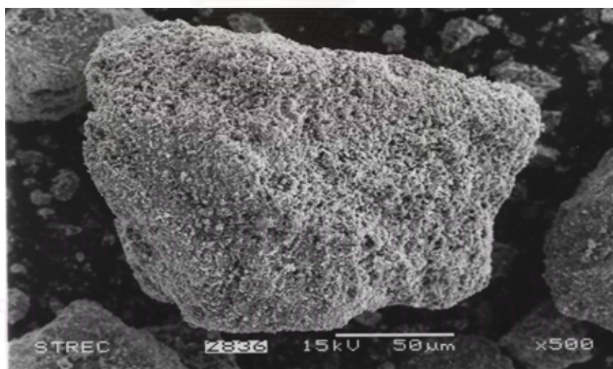
รูปที่ 4.3 ตัวเร่งปฏิกิริยา Cu/MBP ก่อนการเกิดปฏิกิริยาแอมมอกซิเดชัน
