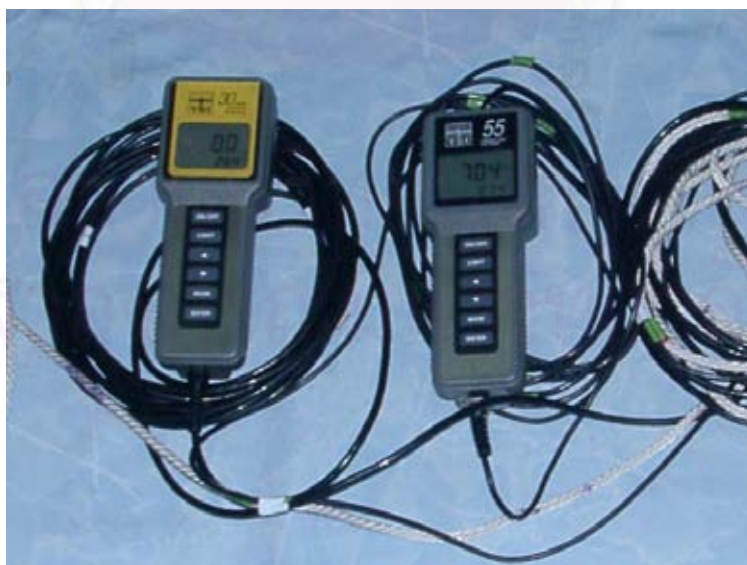
รูปที่ 16 อุปกรณ์วัดอุณหภูมิ ความเค็ม และปริมาณออกซิเจนละลาย
