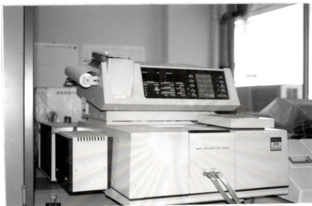
ภาพที่ 4 แสดงเครื่อง HITACHI 220A SPECTROPHOTOMETER ซึ่งเป็นยูวีสเปกโตรโฟโตมิเตอร์
