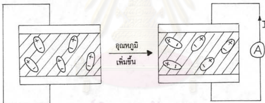
รูปที่ 3.4.3 แสดงลักษณะไดโพลภายในแผ่นพอลิเมอร์ และทิศทางการไหลของประจุเมื่อแผ่นฟิล์มได้รับอุณหภูมิเพิ่มขึ้น
