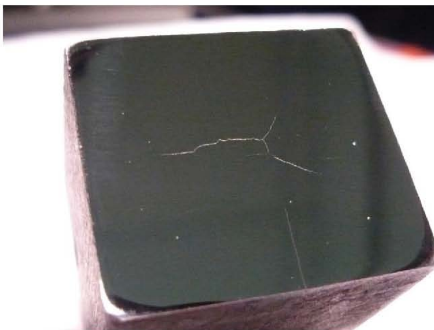
รูปที่ 4.3 อุณหภูมิอบให้เป็นออสเทนไนต์ 900°C และอบคืนตัว (ก) กัดผิวของชิ้นงานด้วยสารละลาย nital 2%, 200x (ข) รอยแตกที่ผิวชิ้นงาน
