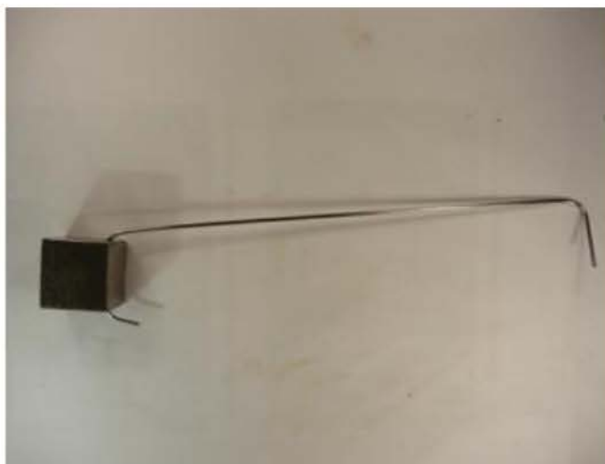
รูปที่ 3.2 ชิ้นงานที่ผูกหลอดทนความร้อน สำหรับแขวนชิ้นงานขณะผ่านกรรมวิธีทางความร้อน
