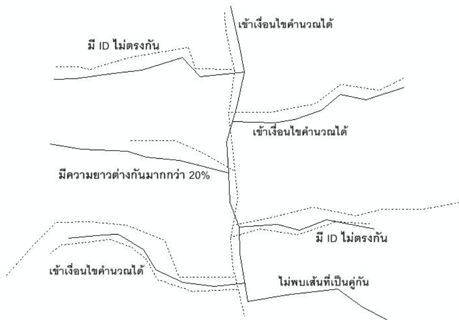
ภาพที่ 4.8 แสดงการตรวจสอบเงื่อนไขของชุดข้อมูลเส้น
