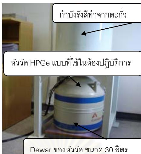
รูปที่ 3.8 กำบังรังสีทำจากตะกั่ว และหัววัด HPGe แบบที่ใช้ในห้องปฏิบัติการ
