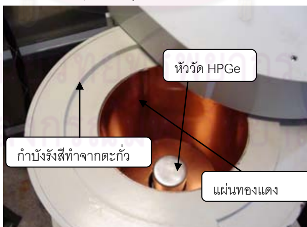
รูปที่ 3.7 หัววัดรังสีแกมมาแบบเจอร์มาเนียมบริสุทธิ์ กำบังรังสีทำจากตะกั่ว
