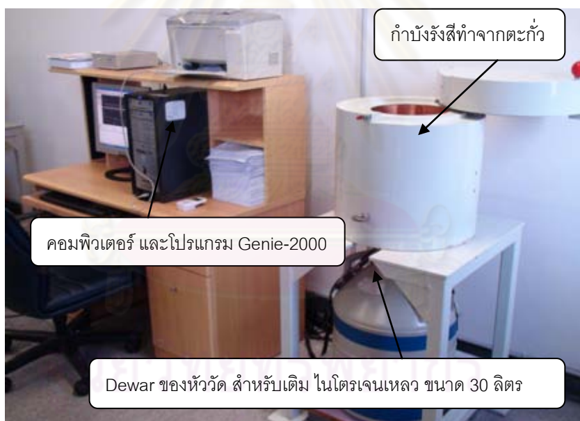
รูปที่ 3.3 ระบบวิเคราะห์สเปกตรัมของรังสีแกมมาแบบเจอร์มาเนียมบริสุทธิ์
