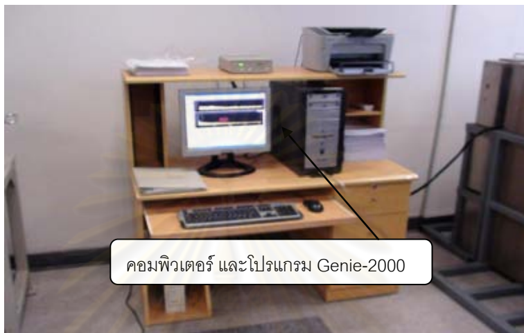
รูปที่ 3.6 โปรแกรม Genie-2000 สำหรับวิเคราะห์สเปกตรัมรังสีแกมมา
