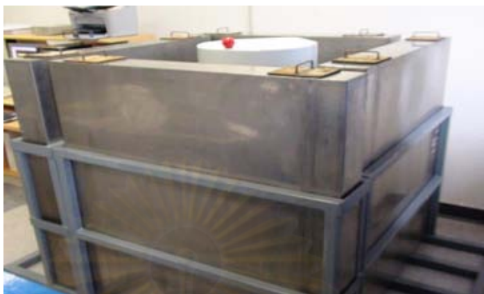
รูปที่ 3.24 กำบังรังสีตะกั่ว และภาชนะเหล็กกล้าไร้สนิมบรรจุน้ำเต็ม
