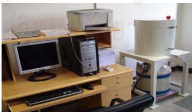
รูปที่ 3.23 ระบบวัดสเปกตรัมของรังสีแกมมากับกัมมันตรังสีทำจากตะกั่ว
