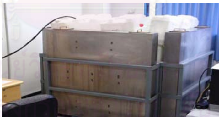
รูปที่ 3.25 กำบังรังสีตะกั่ว ภาชนะเหล็กกล้าไร้สนิม และพลาสติกสำหรับใส่น้ำประปา
