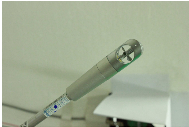
รูปที่ 3.6 หัวโพรบ Vane Type K (NiCr-Ni) สำหรับวัดความเร็วลม
