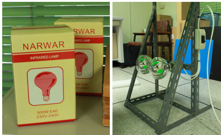
รูปที่ 3.1 หลอดไฟอินฟราเรดที่ใช้ในการให้ความร้อนกับวัสดุในการทดลอง
