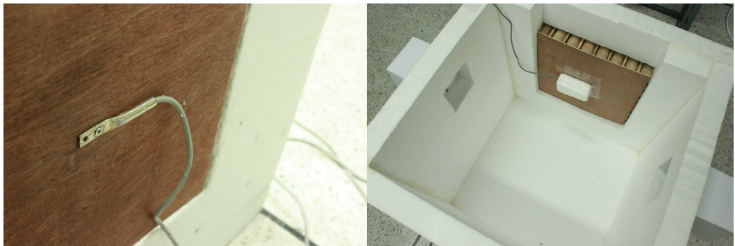
รูปที่ 3.14 การติดเซ็นเซอร์ของเครื่องเก็บข้อมูลอุณหภูมิเข้ากับวัสดุ
