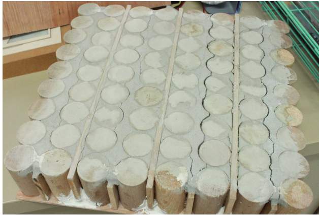
รูปที่ 3.10 วัสดุไม้จริงที่ปิดช่องว่างระหว่างไม้ด้วยคอนกรีต
