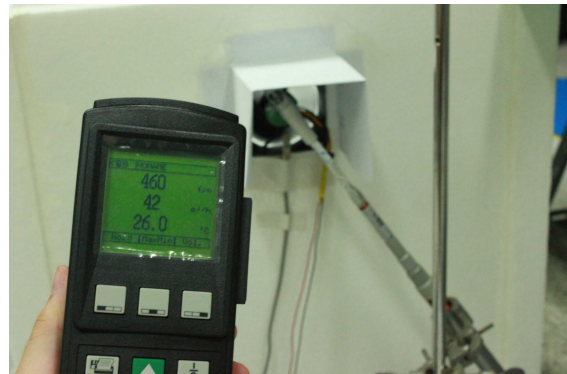
รูปที่ 3.15 แสดงการวัดความเร็วลมของพัดลมระบายอากาศเพื่อคำนวณหา CFM
