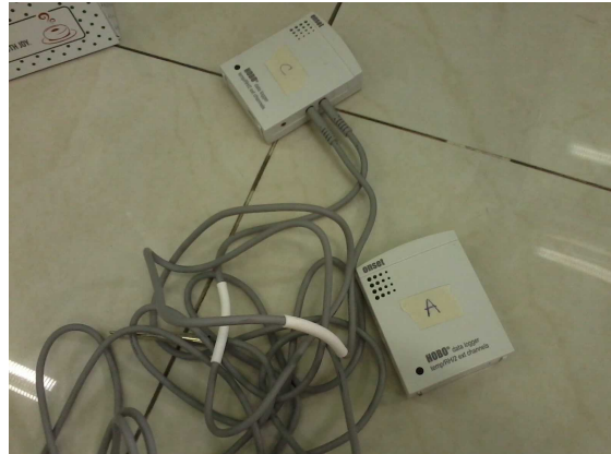
รูปที่ 3.4 อุปกรณ์เก็บข้อมูลอุณหภูมิ HOBO ที่ใช้ในการเก็บข้อมูลอุณหภูมิในกล่องทดลอง
