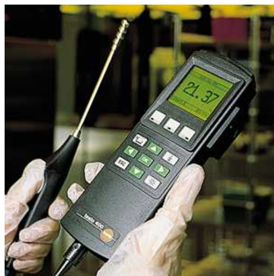
รูปที่ 3.5 อุปกรณ์วัดอุณหภูมิ ความชื้น และความเร็วลม Testo 400
