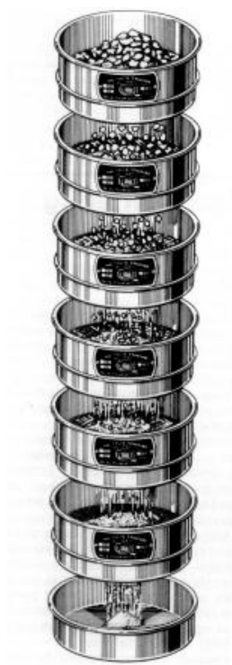
ภาพที่ 2.1 แสดงลักษณะกระบวนการ Sieve [5]
