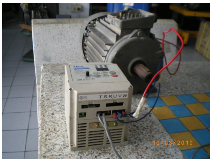
ภาพที่ ง.8 Inverter ควบคุมมอเตอร์ตัวขับเคลื่อน
