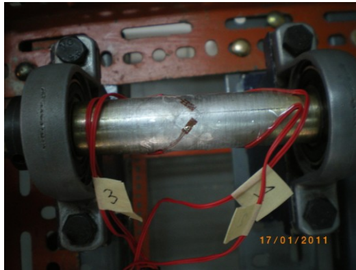
ภาพที่ ข.2 ตำแหน่งการติด strain gage ที่เพลลาจริง
