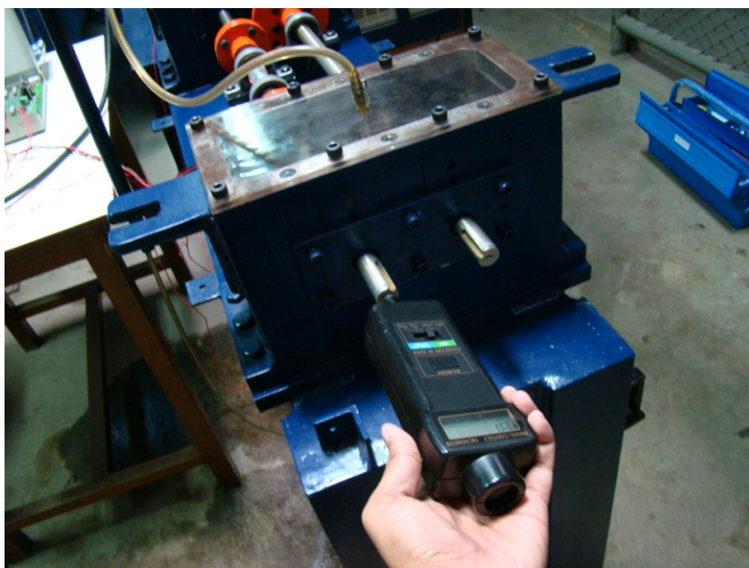
ภาพที่ ค.7 การวัดความเร็วรอบการหมุนของเพลาโดยใช้เครื่องวัดความเร็วรอบแบบสัมผัส
