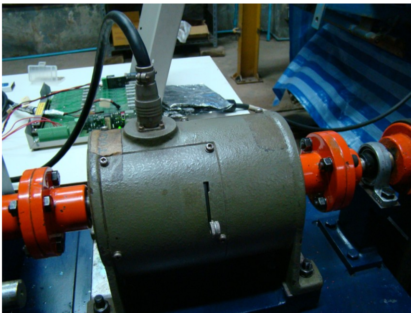
ภาพที่ ค.3 การยึดสลักเกลียวที่คัปปลิ่งที่เชื่อมต่อเพลลาจากห้องเกียร์กับอุปกรณ์วัดแรงบิด
