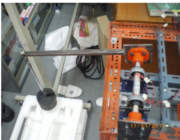
ภาพที่ ข.7 การถ่วงน้ำหนักที่แขนถ่วงน้ำหนักเพื่อให้แรงบิดที่เพลา
