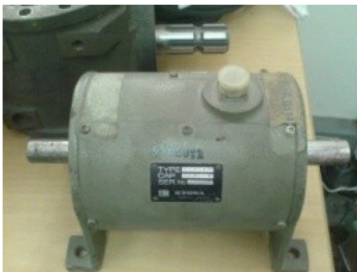
ภาพที่ 4 อุปกรณ์วัดแรงบิด (Torque transducer)
