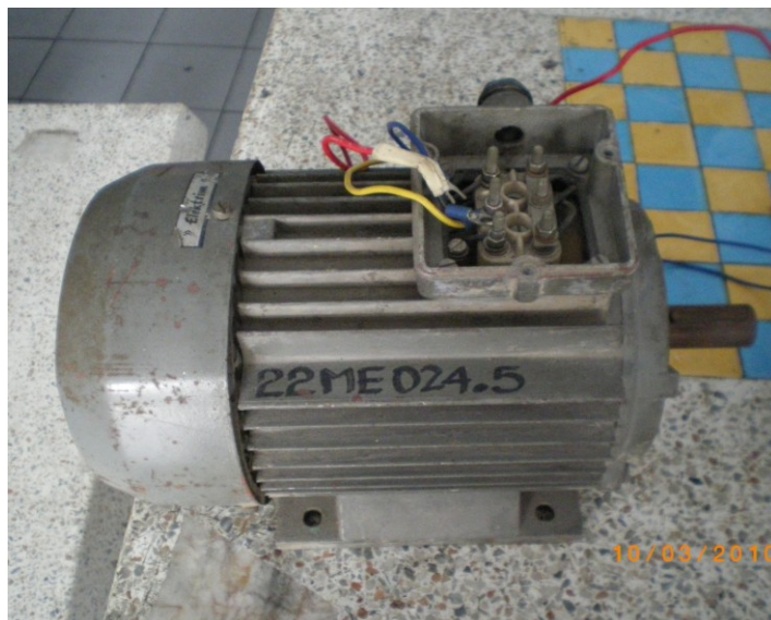
ภาพที่ ง.7 มอเตอร์ไฟฟ้า (ตัวขับเคลื่อนน้ำมันหล่อลื่น)
