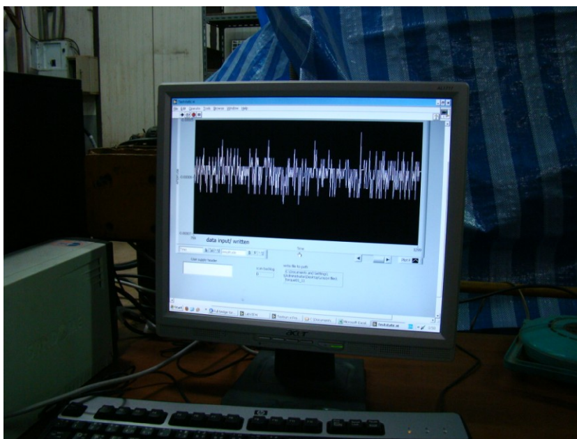
ภาพที่ ค.6 การเก็บค่าแรงบิดก่อนเข้าห้องเกียร์โดยใช้โปรแกรม labview ในการเก็บค่า
