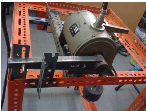
ภาพที่ ๑.๙ การติดตั้ง torque transducer บนโครงสอบเทียบ
