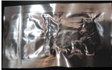
ภาพที่ 3.4 ภาพถุงอะลูมิเนียมเนียบหลังปิดผนึกในสุญญากาศ
