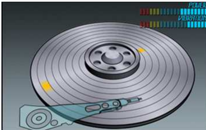
ภาพที่ 5.1 ตำแหน่งของหัวอ่าน/เขียนอยู่ที่กึ่งกลางแผ่นบันทึกข้อมูล
