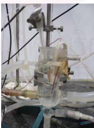
Organ bath ขนาด 25 ml สำหรับเลี้ยงเนื้อเยื่อ
