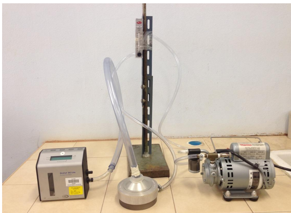
ภาพที่ ซ-1 การจัดวางอุปกรณ์สำหรับการทดสอบความเที่ยงตรงของปั๊มดูดอากาศ
