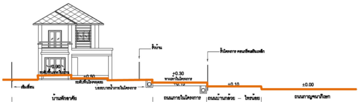
ภาพที่ 4.48 แสดงระดับพื้นโครงการ (รูปตัดแสดงระดับพื้นโครงการ)
