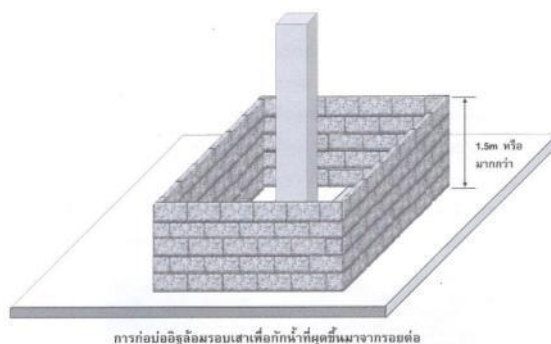
ภาพที่ 2.9 แสดงการทำคันกั้นทรายบริเวณน้ำซึมใต้พื้น
