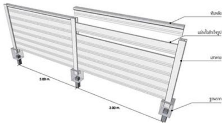
ภาพที่ 4.55 แสดงการติดตั้งรั้วคอนกรีตสำเร็จรูป ที่มา; http://www.homemartnkc.com
