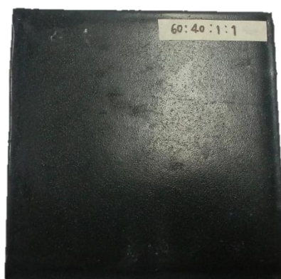
ภาพที่ 4.4 ตัวอย่างชิ้นงานที่มีส่วนผสมของโบรอนออกไซด์และผงเขม่าดำที่ขึ้นรูปได้ (อัตราส่วนน้ำยาทางพาราธรรมชาติ : น้ำยาสไตรีนบิวทาไดอิน 60 : 40 ผสมผงเขม่าดำ 1 กรัม และโบรอนออกไซด์ 1 กรัม)
