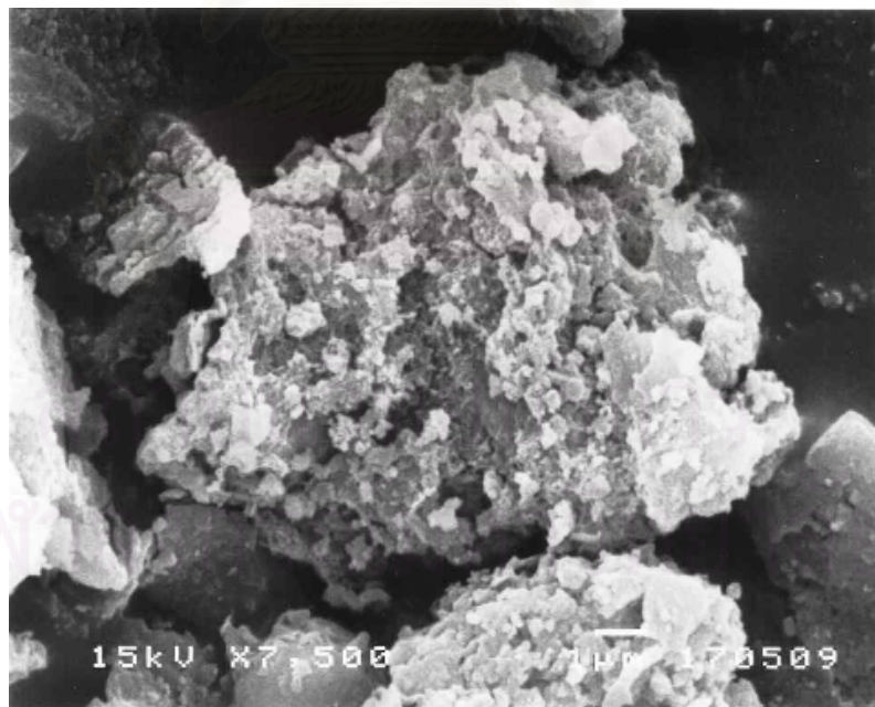
รูปที่ 4.22 แสดงโครงสร้างและพื้นผิวของซีโอไลต์ที่สังเคราะห์จากเถ้าลอยถ่านหินหลังจากการดูดติดผิว
