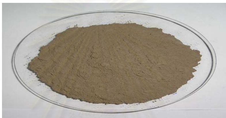
รูปที่ 4.1 เถ้าลอยถ่านหินที่ถูกจับไว้ด้วยเครื่องตกตะกอนไฟฟ้าสถิต
