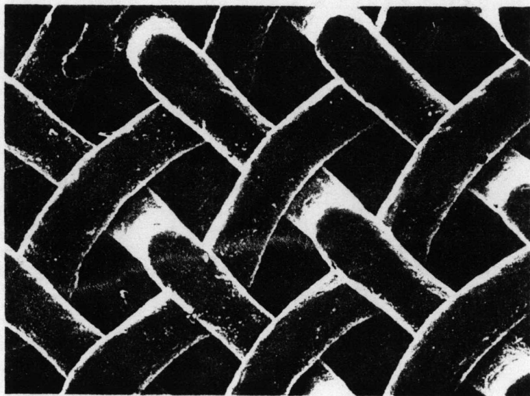
รูปที่ 16 ฐานของแบรกเกตใหม่ถ่ายด้วยกล้องจุลทรรศน์อิเล็กตรอนแบบส่องกราด (กำลังขยาย 80 เท่า ) (14)
