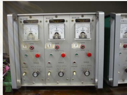
ข) อุปกรณ์รับสัญญาณอนาล็อกเครื่องวัดความสูงคลื่น
