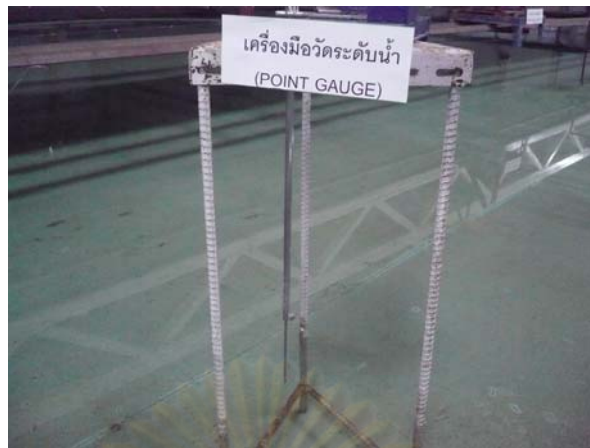
รูปที่ ก-3 เครื่องมือวัดระดับ (point gauge)
