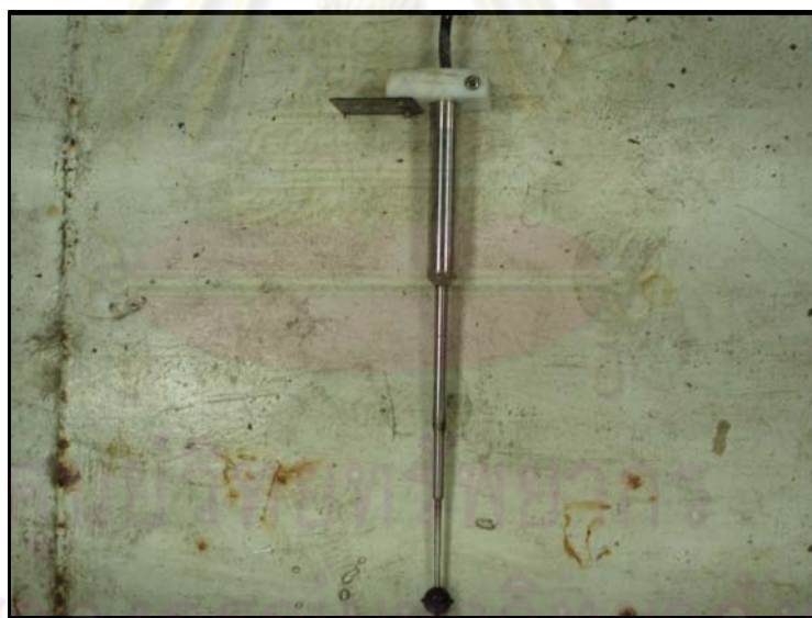
รูปที่ 3-6 เครื่องมือวัดความเร็วการไหลแบบ 3 ทิศทางของ OSK รุ่น ACM 300-D
