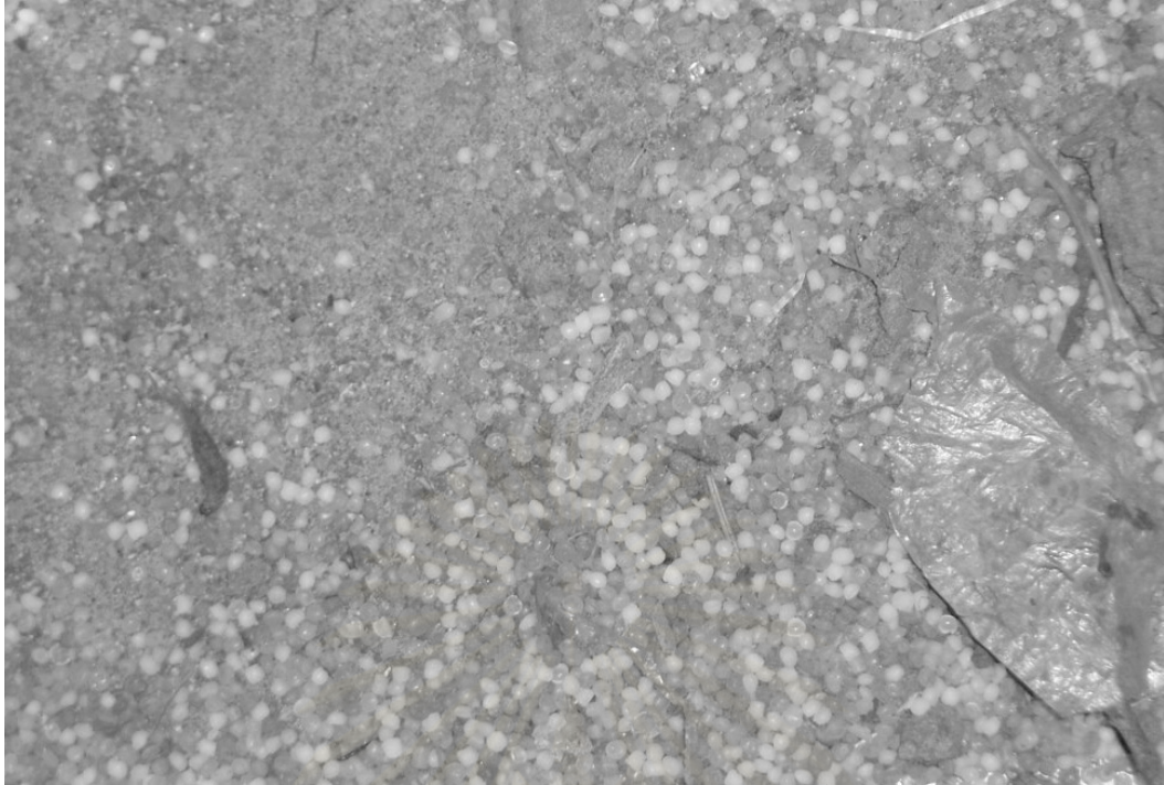
ภาพที่ 3-3 เม็ดพลาสติกผสมที่ตกหล่นบริเวณพื้นโรงงาน
