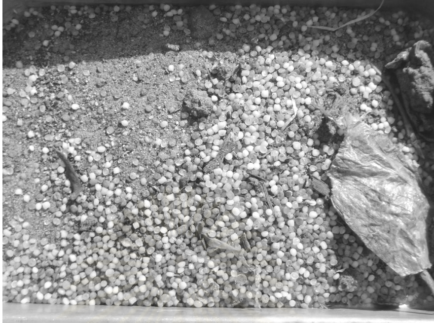
ภาพที่ 1-1 เม็ดพลาสติกผสมที่เกิดจากเศษเหลือทิ้งในโรงงาน
