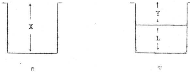
รูป 3.13 ก. ความลึกของท่อสั้นเปล่า ข. ความลึกจากปากท่อสั้นถึงผิวผลึกเหลว
