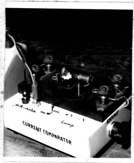
รูปที่ 4.23 เปิดให้เห็นแอล ดี อาร์ และหลอดไฟ
