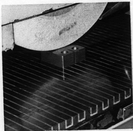
รูปที่ 4.7 ก) แสดงลักษณะการวางชิ้นงานบนแท่นเครื่องเจีย ข) แสดงชิ้นงานที่เสร็จเรียบร้อยแล้ว
