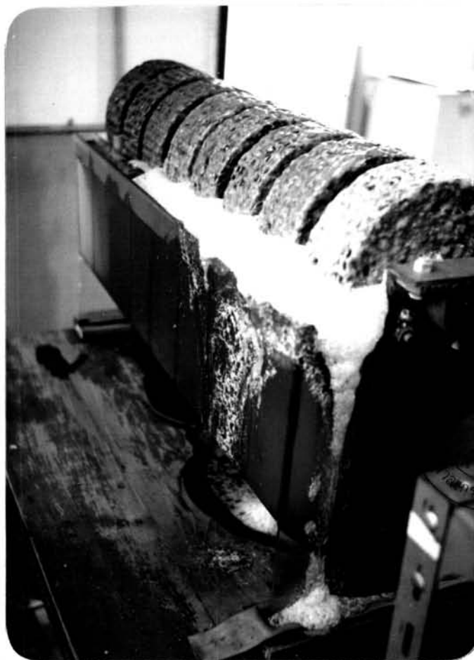
รูปที่ 5.5 ลักษณะของ Biomass และฟองที่เกิดใน Submerged Drum ในช่องแรก ๆ เมื่อ เพิ่มความเร็วของการหมุนใน run ที่ 5 (10rpm)
