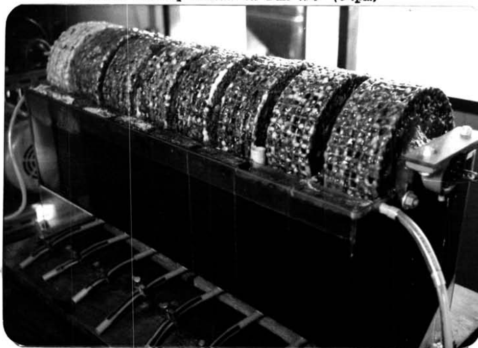
รูปที่ 5.4 ลักษณะของ Biomass บน Submerged Drum และ Scum ที่ เกิดในขณะ Steady State เมื่อ overload ใน run ที่ 4 (5 rpm)
