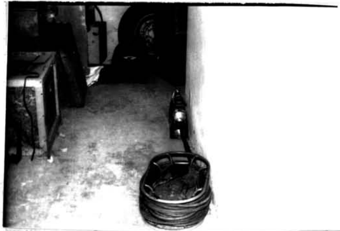
Shield, สายนำสารรังสี, Projector, เครื่องบังคับระยะไกล
