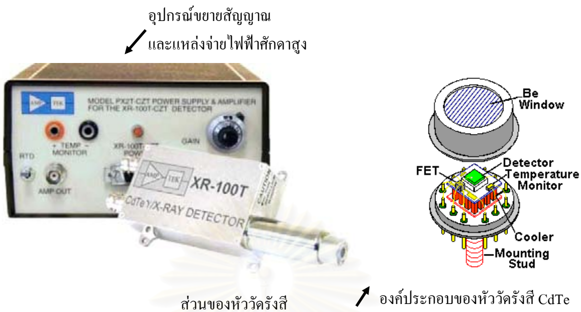
รูปที่ 3.1 หัววัดรังสีแกมมาแบบสารกึ่งตัวนำแคดเมียมเทลลูไรด์ (CdTe detector)
