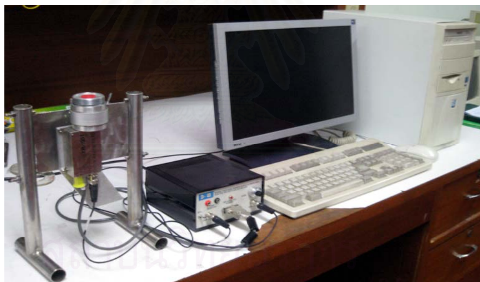
รูปที่ 3.1 หัววัดรังสีแกมมาแบบสารกึ่งตัวนำแคดเมียมเทลลูไรด์ (CdTe detector)
