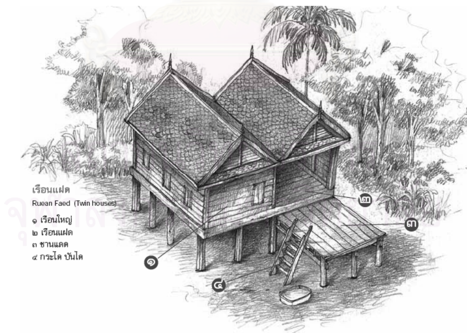
รูปที่ 2.5 แสดงองค์ประกอบของเรือนแฝด
