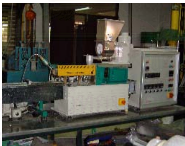
รูปที่ 3.2 เครื่องอัดรีดเกลียวคู่ (twin screw extruder)
