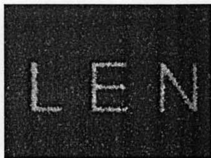
ภาพที่ 4.49 ตัวอักษรขนาด 6 พอยท์ บนกระดาษที่มีสัดส่วนของซิลิกาต่อดินขาวนิวซีแลนด์ต่อ แคลเซียมคาร์บอเนตบด เท่ากับ 58.33 : 8.33 : 33.33 สูตรที่ 13
